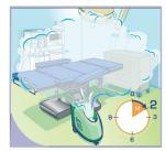
Après le temps de diffusion et 2 h de contact, s'équiper de protections et mettre la récupération forcée en service : attendre 30 min. avant de réutiliser la pièce.
